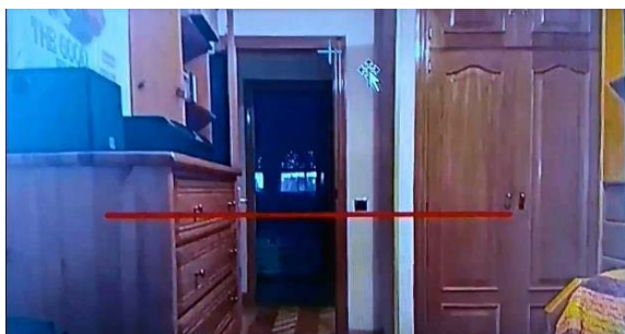
Figura 3: Test 1. Generación de la línea de horizonte utilizando el método de Lucas-Kanade.
